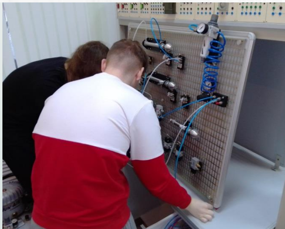
Реалізація функції логічного повторення за допомогою пневматичного логічного клапана «ТАК». (Зліва продемонстровано можливий варіант заміни елемента «ТАК» на розподільник 5/2 відповідної конструкції)
